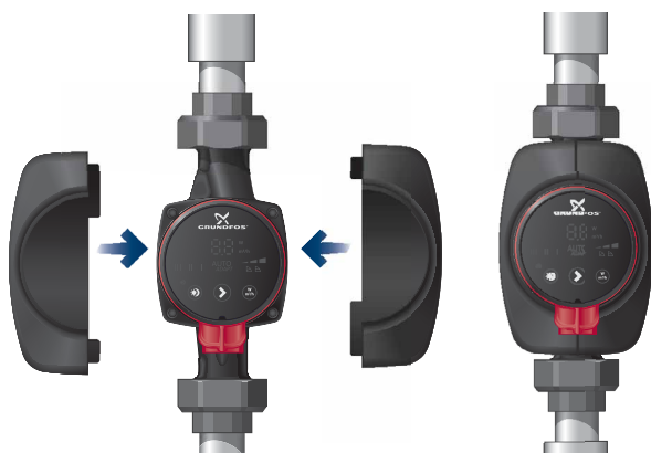
8. pav. Siurblio korpuso izoliavimas
