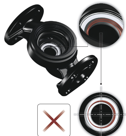
9. pav. Neteisingai centruota sandarinimo sistema
